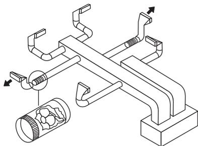
Extracción ó inyección por conducto individual.
